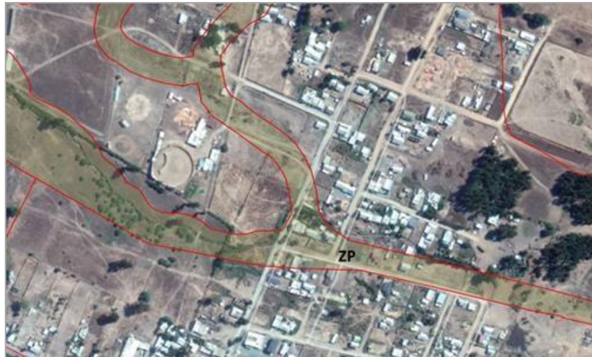
Ilustración 9: Edificaciones sobre Zona de Protección (ZP) de Drenaje PRC Quirihue Vigente
